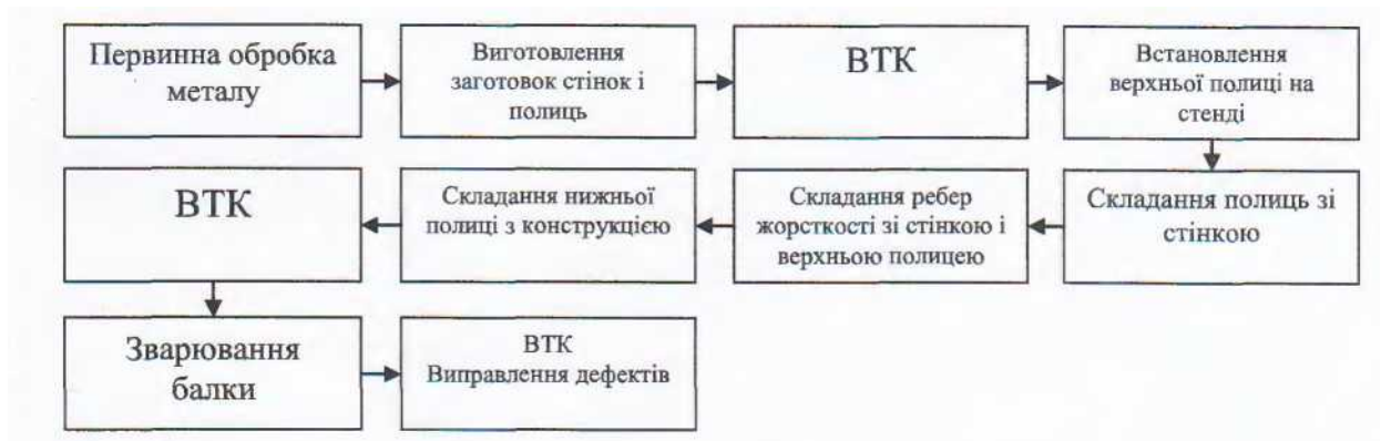
Рис. 3.1 Схема технологічного процесу виготовлення поперечени
