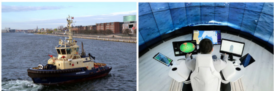
Рисунок 7.3 – Буксир «Svitzer Hermod» (ліворуч) та Центр дистанційного керування (ROC) (праворуч), що використовуються в проекті
