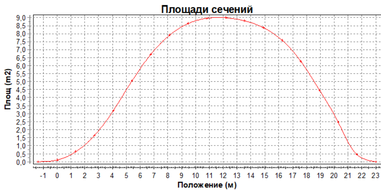
Рис. 2.2 – Площини шпангоутів по довжині судна
