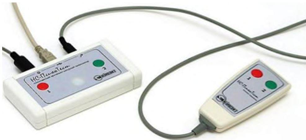
Рис. 1.3. Прилад для виміру реакції вибору.
