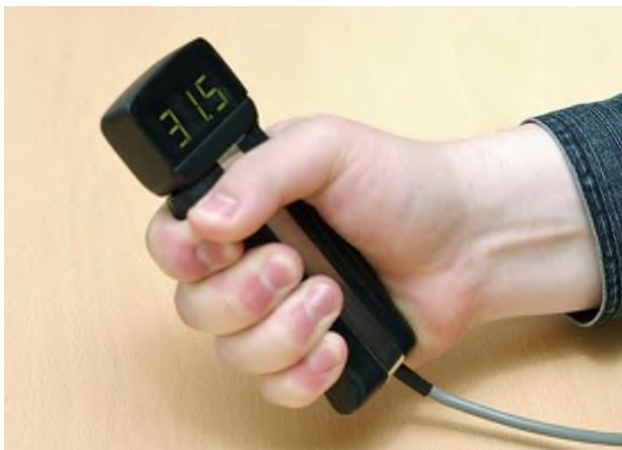
Рис. 1.7. Електронний динамометр для вимірювання сили кист
