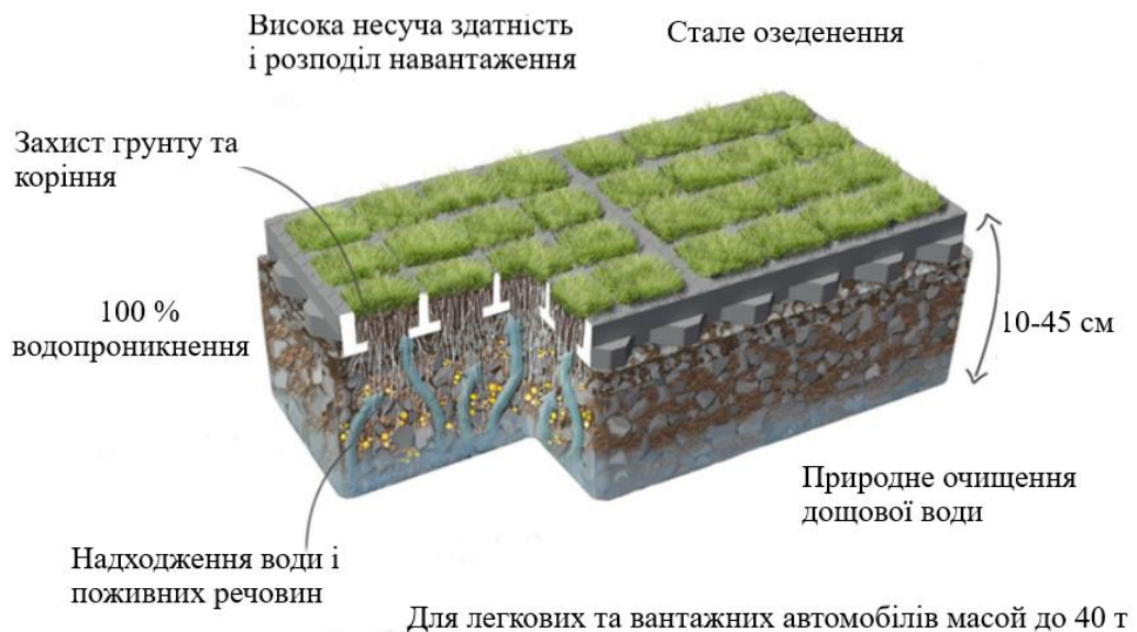
Рис. 3.7. Екологічні та функціональні особливості газонних решіток TTE
