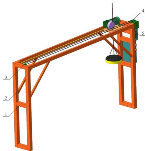
1) – розпірка; 2) – вантажонесучі опори; 3) – ролик; 4) – шків; 5) – ремінь
