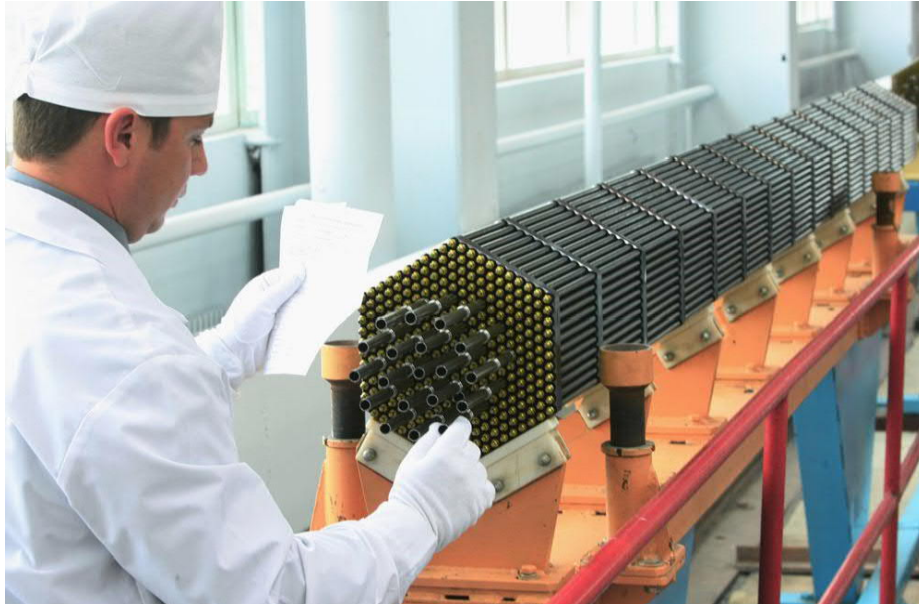
Рис. 4.12. Контроль за якістю виготовлення паливної тепловидільної збірки
