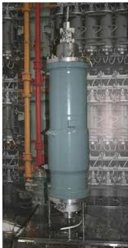
Рис. 4.9. Газова центрифуга для збагачення урану ізотопом-235: а – переріз; б – зовнішній вигляд
