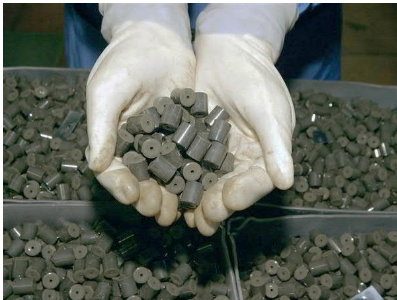
Рис. 4.11. Пігулки ядерного палива для реактора на теплових нейтронах
