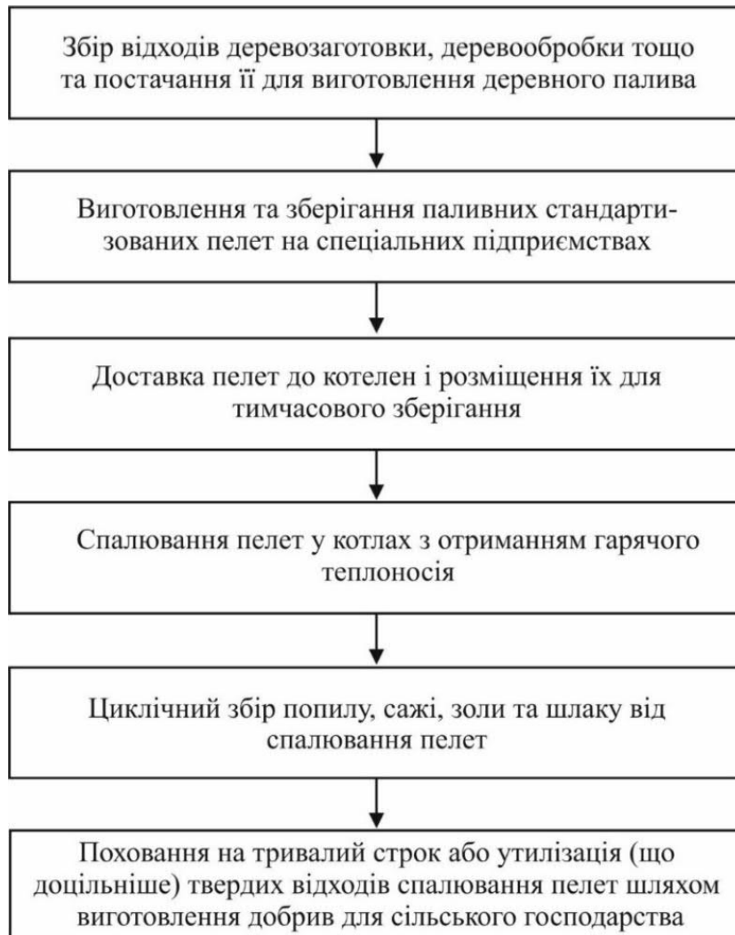
Рис. 5.8. Характерні стадії виробництва та застосування деревних пелет і утилізація відходів від їх спалювання
