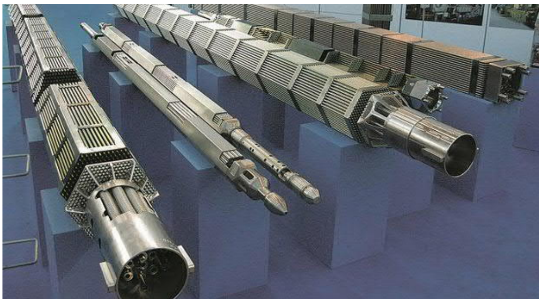
Рис. 4.13. Пучки ТВЕЛів сучасних ядерних реакторів
