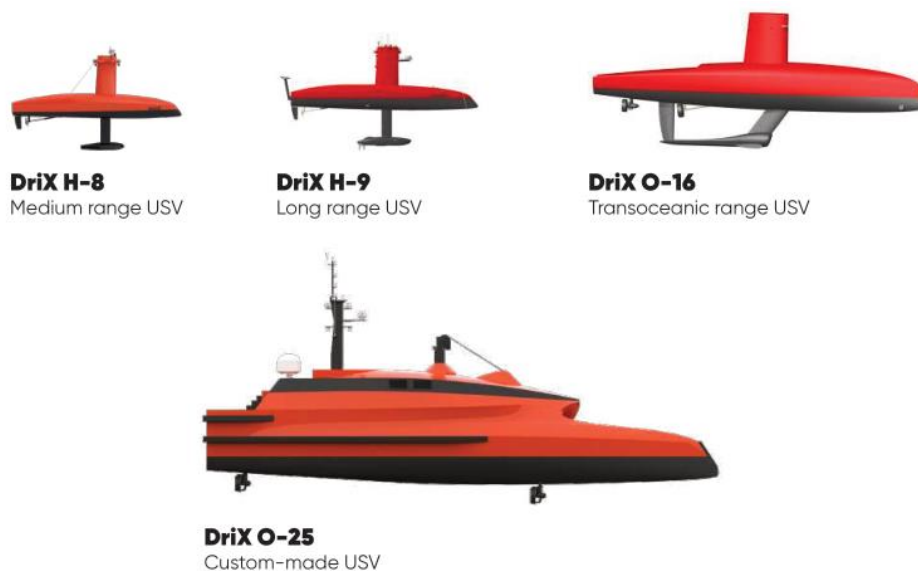
Рисунок 4.5 – Безкіпажні надводно-підводні судна DriX компанії iXblue як приклад можливого архітектурно конструктивного типу МБНПС
