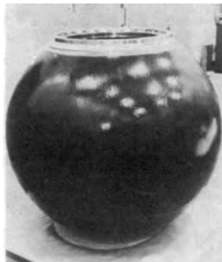
Рисунок 1.14 – Экспериментальная модель сферического прочного корпуса из углепластика AS4C/PPS диаметром 1,22 м с титановыми подкрепляющими кольцами [82]
