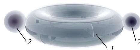
1 – тороидальный корпус; 2 – сферический корпус Рисунок 1.3 – Проект подводного жилища Atlantis II [28]
