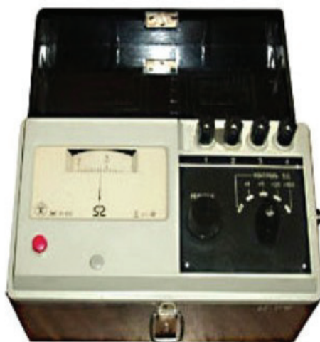
Рис. 3.2. Вимірювач опору заземлення М416
