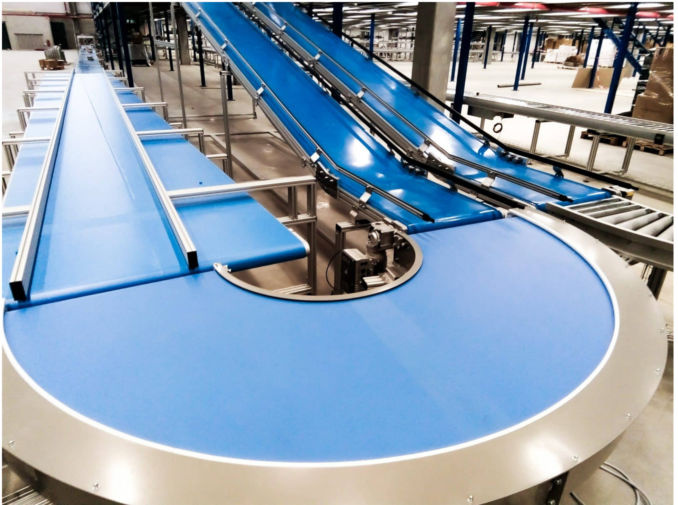
Рисунок 1.1 Стрічковий конвеєр з поворотною секцією у текстильному виробництві
