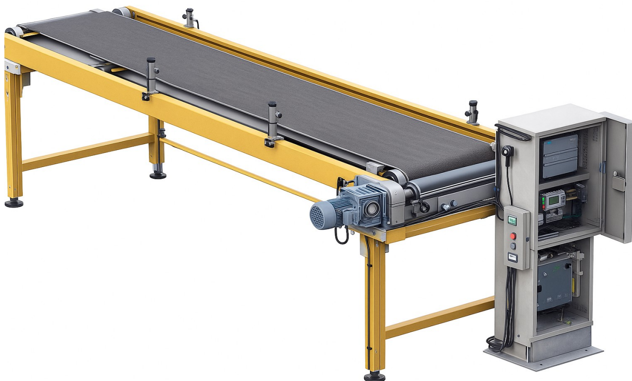
Рисунок 3.3 – 3D-прототип стрічкового конвеєра для системи транспортування текстильних матеріалів
