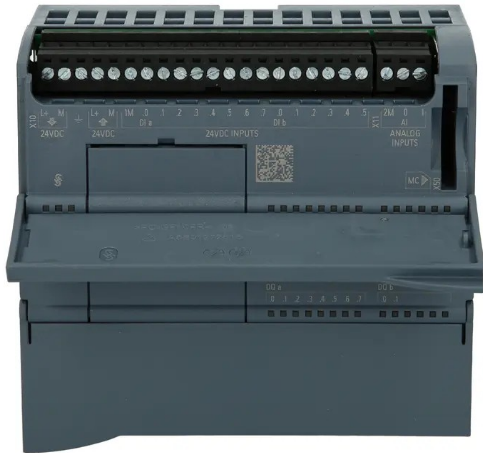
Рисунок 3.2 – Клемна панель та роз’єми підключення ПЛК Siemens S7-1200
