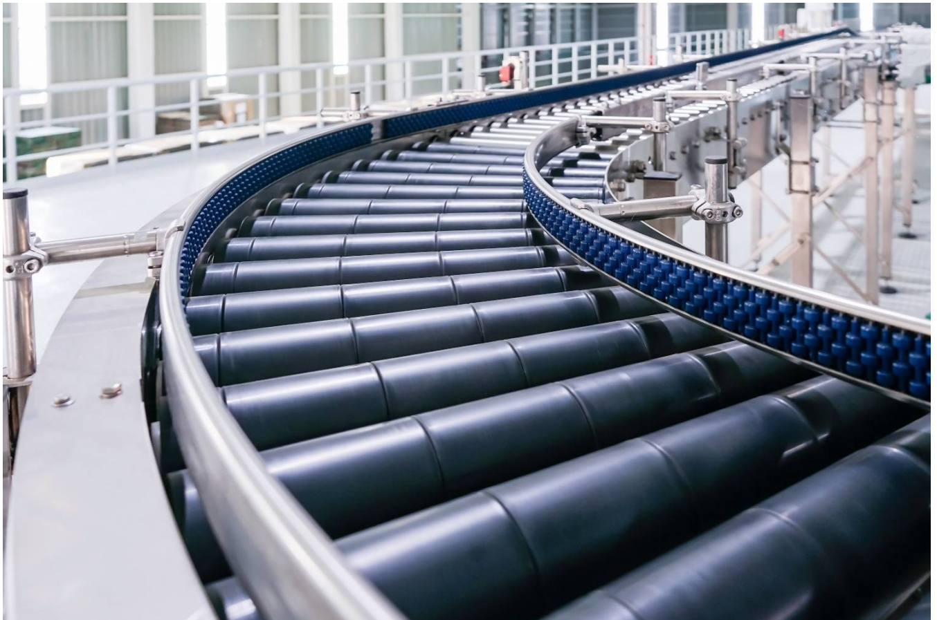
Рисунок 1.2 – Поворотний роликовий конвеєр для транспортування рулонів
