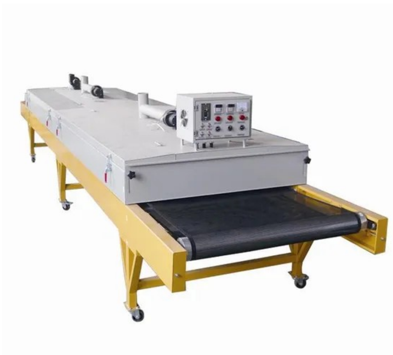
Рисунок 1.4 – Конвеєр тунельної сушильної установки для текстильних матеріалів
