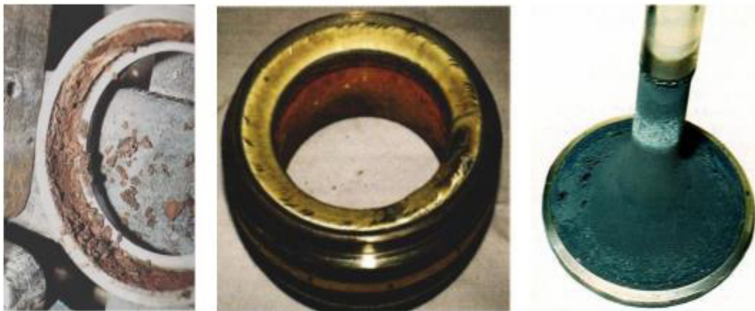
Рисунок 3.3 - Пошкодження сідел клапанів (зліва та посередині) та випускний клапан дизеля Vasa 32 після 10000 годин роботи на важкому паливі (справа)
