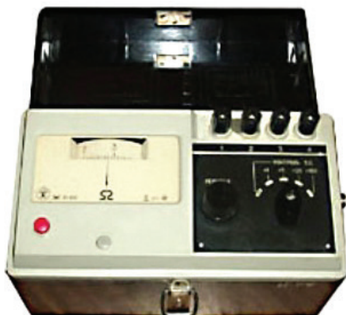
Рис. 3.2. Вимірювач опору заземлення М416
