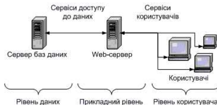
Рис.1.4 – Триланкова фізична архітектура програмного забезпечення інформаційної системи
