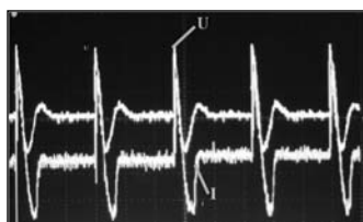
Рис. 4. Осциллограмма тока и напряжения высокочастотного стримерного разряда. Развертка 250 мкс/дел.
