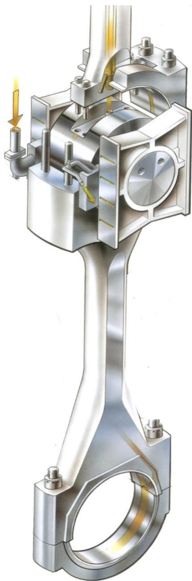
Рис. 1.17. Підвід циркуляційного масла до крейцкопфа та масляні канали у штоці, підшипниках і шатуні
