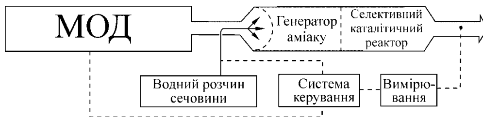
Рис. 3.17. Принципова схема системи селективного каталітичного відновлення азоту у відхідних газах
