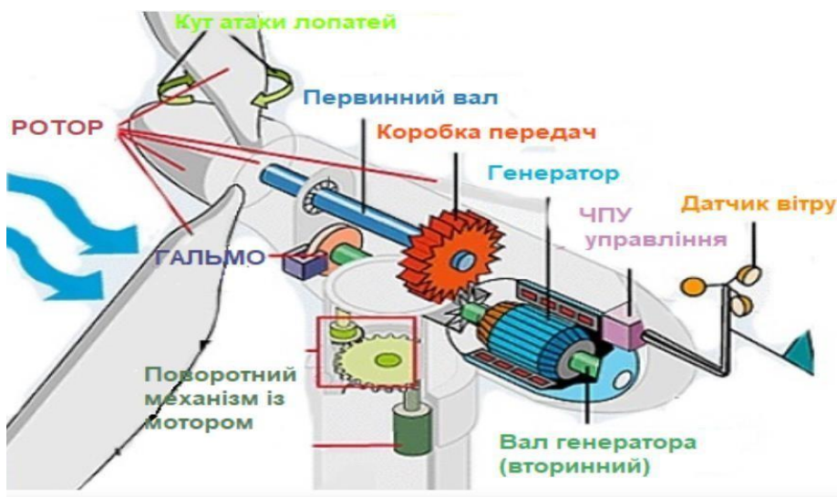
Рисунок 2.7(а) – Будова вітрогенератора
