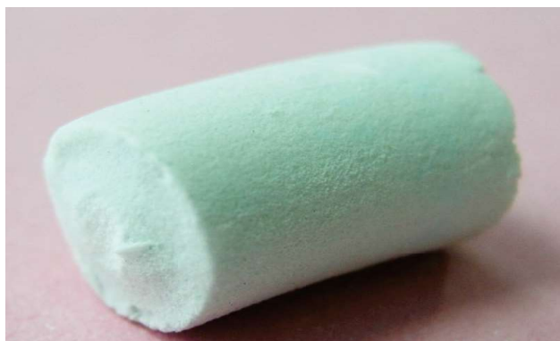
Рис. 2. Зовнішній вигляд експериментального зразку після термічного оброблення при t = 300\text{ }^{\circ}\text{C}
