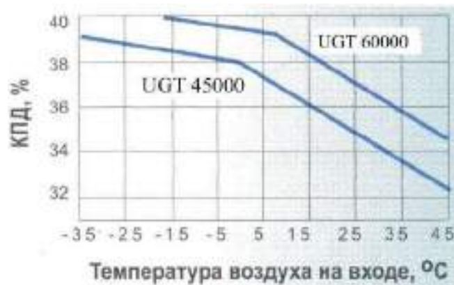
Рис.2.4. Залежність потужності та ККД двигунів UGT 45000 та UGT 60000 від температури зовнішнього повітря
