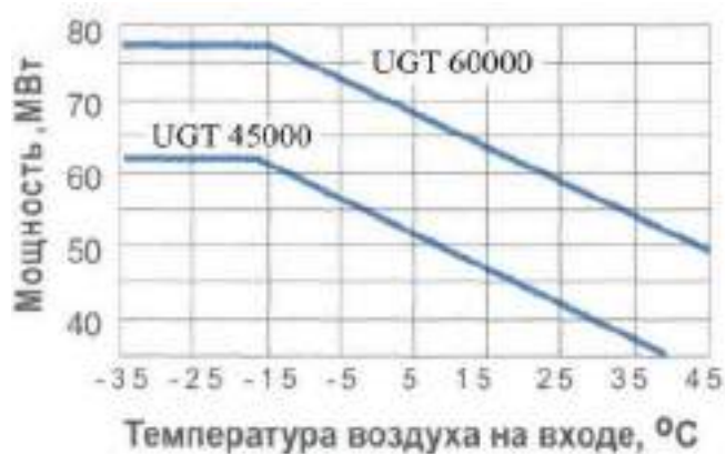
Рис.2.4. Залежність потужності та ККД двигунів UGT 45000 та UGT 60000 від температури зовнішнього повітря
