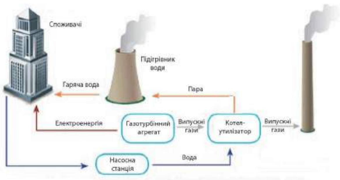
Рис.1.1. Схема газотурбінної ТЕЦ опалювального типу
