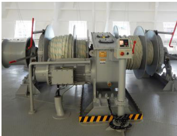
Рисунок 1.6 – Швартові лебідки (а) в причальному приміщенні (б) [1 - 3]
