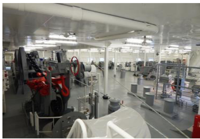
Рисунок 1.6 – Швартові лебідки (а) в причальному приміщенні (б) [1 - 3]
