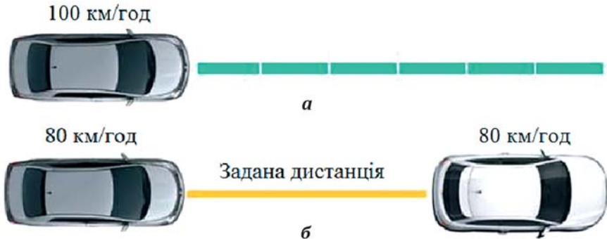
Рисунок 3.9 – Робота системи адаптивного круїз-контролю: а – перешкоди відсутні, автомобіль рухається із заданою швидкістю; б – система круїз-контролю виявила попереду транспортний засіб, вирівнює швидкість з його швидкістю і тримає заданий інтервал
