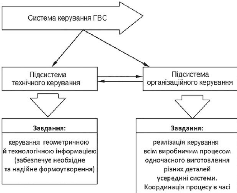
Рисунок 5.7 – Підсистеми керування ГВС
