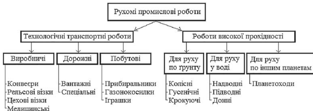
Рисунок 3.5 – Класифікація рухомих промислових роботів
