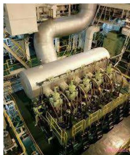
Рис. 2. Головний двигун 5S60MC [3]
