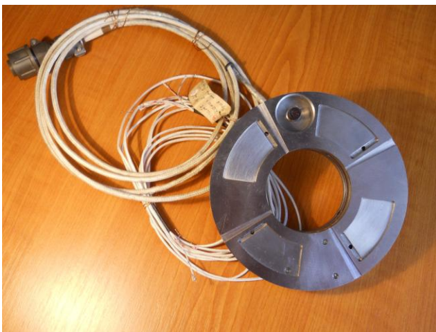
Експериментальний зразок гідростатодинамічного під'ятника зі ступен'ю Релея
