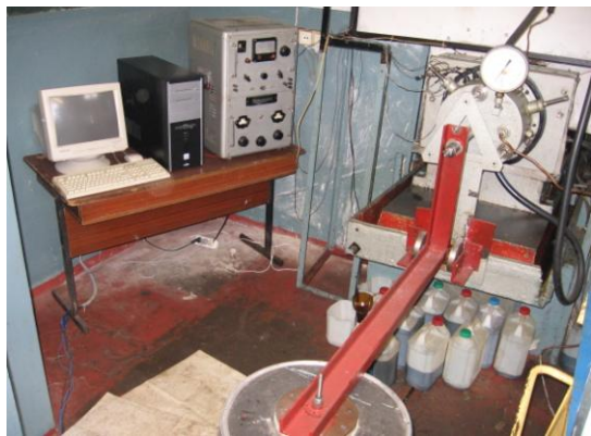
Сучасний автоматизований експериментальний стенд для досліджень та доводки важконавантажених упорних підшипників ковзання
