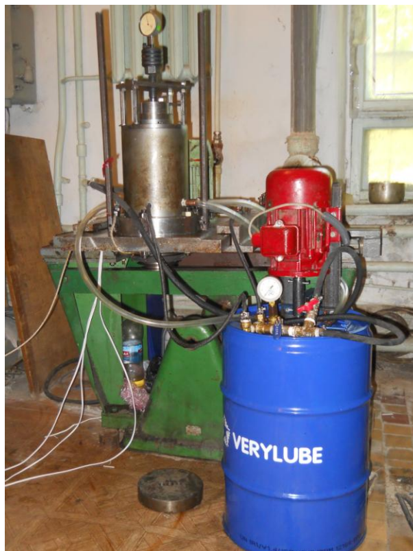
Експериментальний стенд для відпрацювання слабонавантажених підшипників різноманітного призначення
