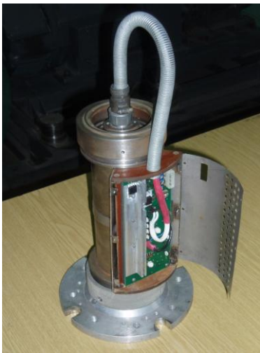
Електромагнітний динамічний віброгасник
