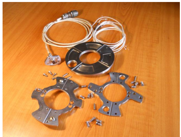
Експериментальний зразок гідростатодинамічного під'ятника зі ступен'ю Релея
