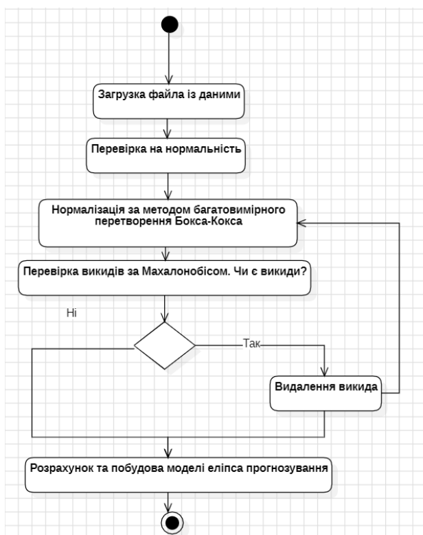
Рисунок 3.3 – Діаграма діяльності варіантів використання програми для оцінювання складності об'єктно-орієнтованого проектування Java-застосунків
