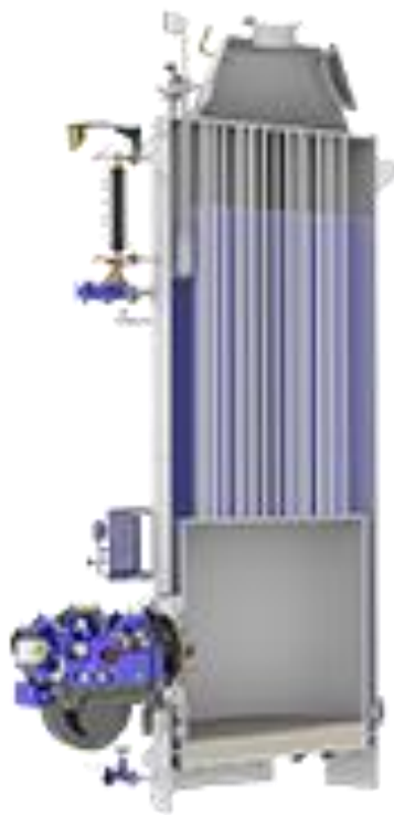
Рис.4.2 Компоувальна схема газотрубного котла Kangrim PA
