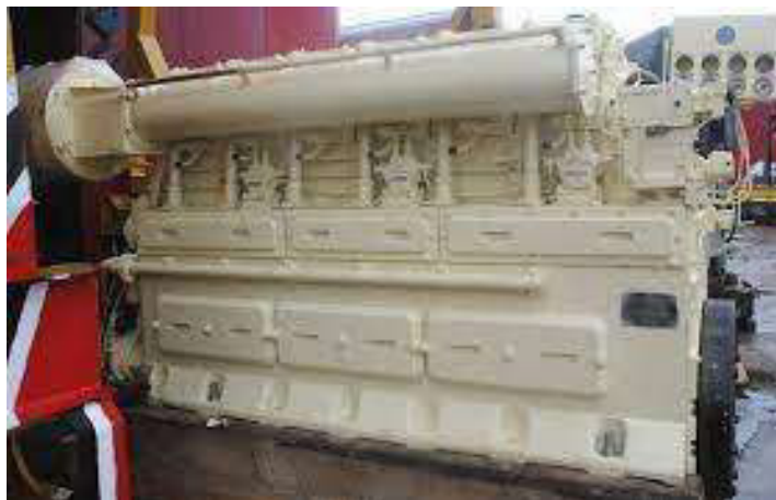
Рис. 1.1 – Двигун 6Ч 23/30 в якості силового агрегату для генератору ДГР2А
