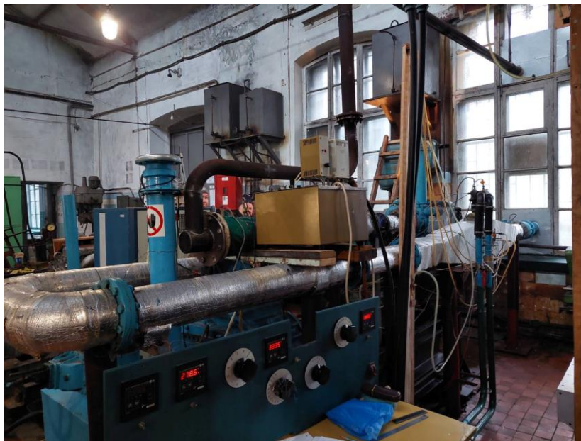
Рисунок 2.6 – Стенд з експериментальним зразком моделі ШГТА: 1 – дизельний двигун СМД-19; 2 – модель дослідного зразка ШГТА; 3 – теплоакumuлюючий матеріал; 4 – газохід; 5 – заспокійливий бак; 6 – звужувальний пристрій; 7 – мікроманометр ММН-240; 8 – ємність термостату; 9 – насос; 10 – трубопроводи; 11 – пульт інформаційно-вимірювальної системи; 12 – багатофункціональний двоканальний вимірювач-регулятор ОВЕН2ТРМ1; 13 – лемніската; 14 – п'єзометри; 15, 16, 17 – гребінка термопар ТХК 5-ти точкова, 18 – термометр
