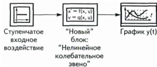
Рисунок 3.7.1. Структурна схема моделювання перехідного процесу нелінійної коливальної ланки, зображена з використанням блоків бібліотек ПК «МВТП»
