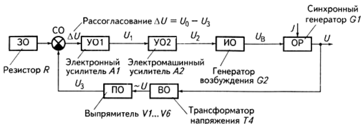
Рисунок 2.3. Функціональна схема САР напруги синхронного генератора:
