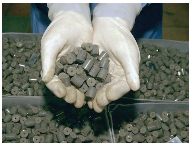
Рис. 5.11. Таблетки ядерного палива для реактора на теплових нейтронах
