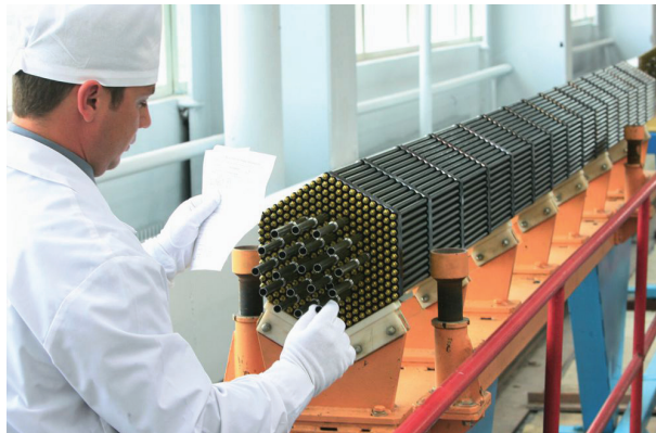
Рис. 5.12. Контроль за якістю виготовлення паливної тепловидільної збірки
