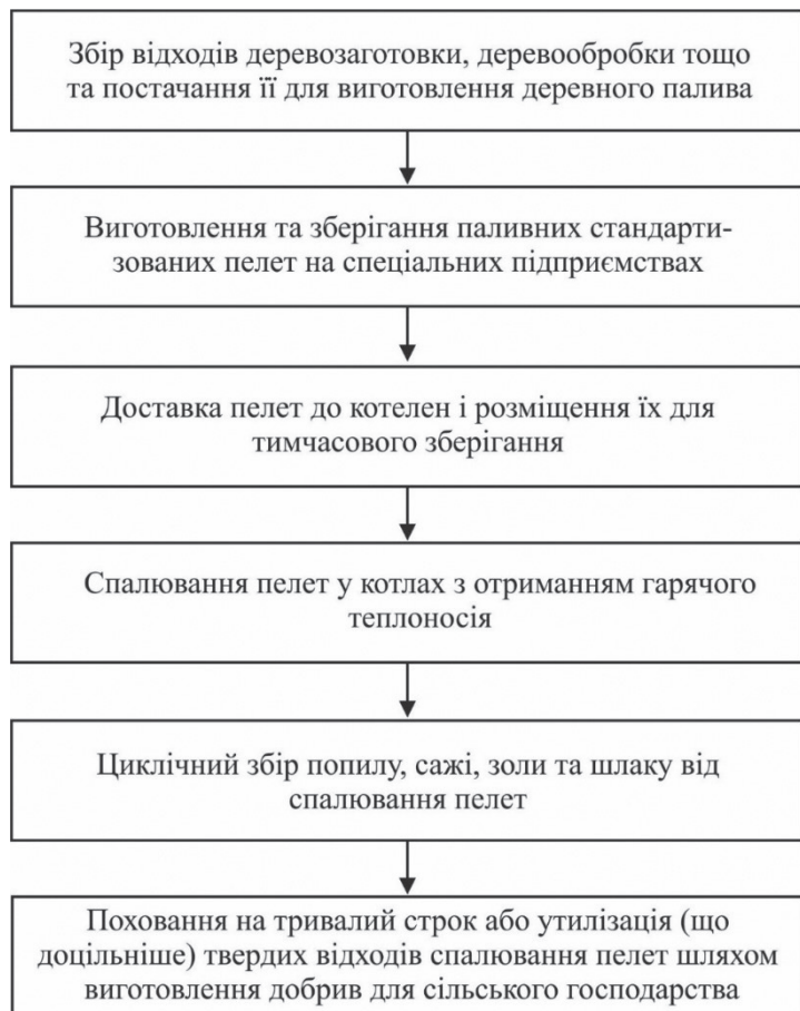
Рис. 6.10. Характерні стадії виробництва й застосування деревних пелет та утилізація відходів від їх спалювання
