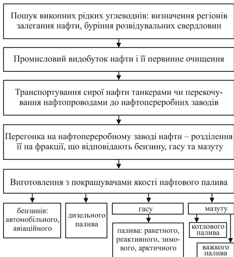
Рис. 3.11. Етапи виробництва нафтових палив
