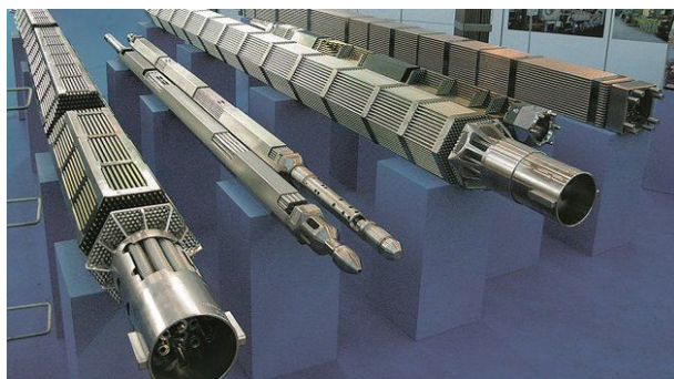
Рис. 5.13. Пучки ТВЕЛів сучасних ядерних реакторів
