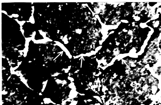
Рис. 4. Карбіди M_{23}C_6 по границях зерен \alpha -фази, стрілки; \times 5000
