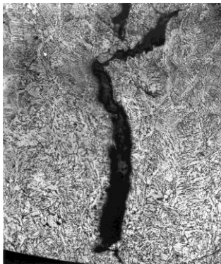
Рис. 7. Тріщина втоми, що розвивається по відманштеттовій структурі ділянки перегріву зони термічного впливу сталі 15X1M1Ф; x100.
