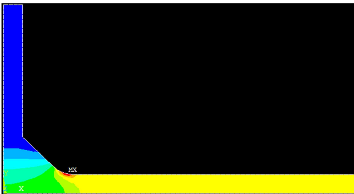
Рис. В.17. Розподіл напружень в околі осередку концентрації напружень у хрестоподібному зварному з'єднанні із радіусом переходу R = 8 мм. Теоретичний коефіцієнт концентрації напружень K_t = 1,38
