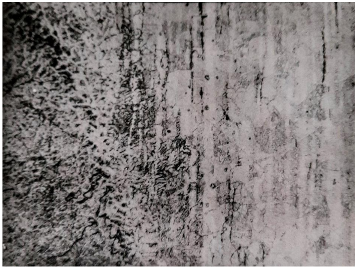
Рисунок 2.15 – Мікроструктура зони сплавлення металу шва та сталі 12X18H10T, збільшена в 100 разів.
