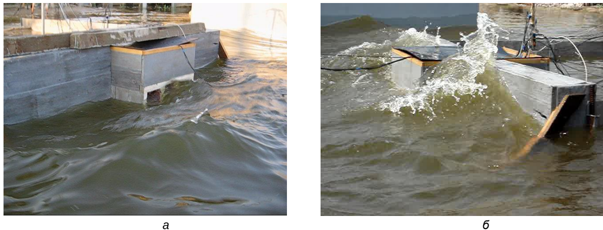
Рис. 4. Хвильове поле перед фронтальною частиною моделі припливної електростанції за умов мінімального (а) та максимального (б) рівня моря
