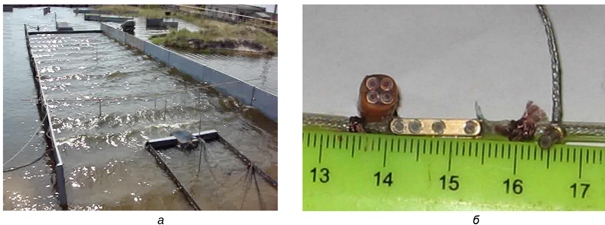
Рис. 2. Хвильовий рух і розташування моделі припливної електростанції у хвильовому басейні(а) та датчики пульсацій тиску (б)
