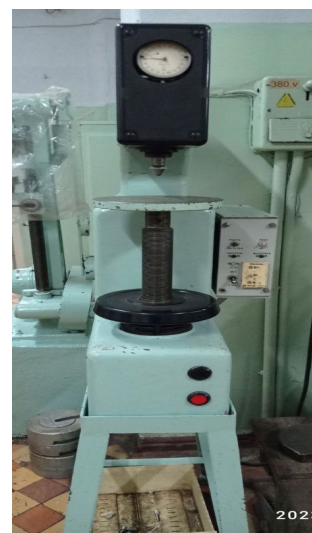
Рис. 2.6. Твердомір Роквелла ТК-2:
