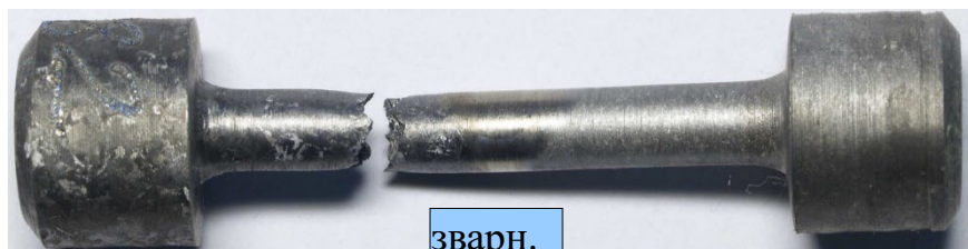
Рис.2.1 – Форма і розрив циліндричного зразку після випробувань на одновісне статичне розтягнення.
