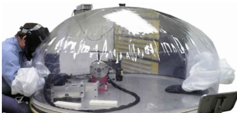
Рис.3.5. Приклад захисної камери для зварювання титану. [17]
