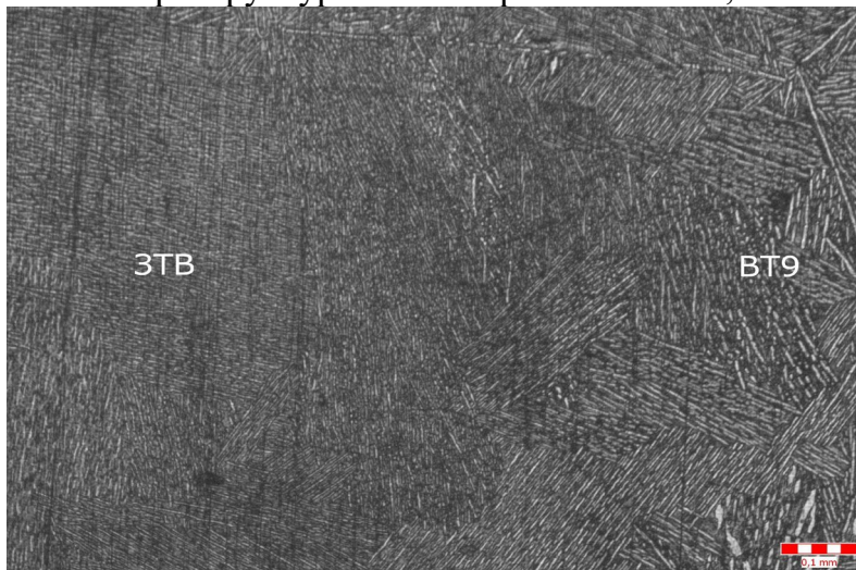
Рис. 3.28. Мікроструктура ЗТВ на зразках №9182, 9183 з боку матеріалу VT9 x100
