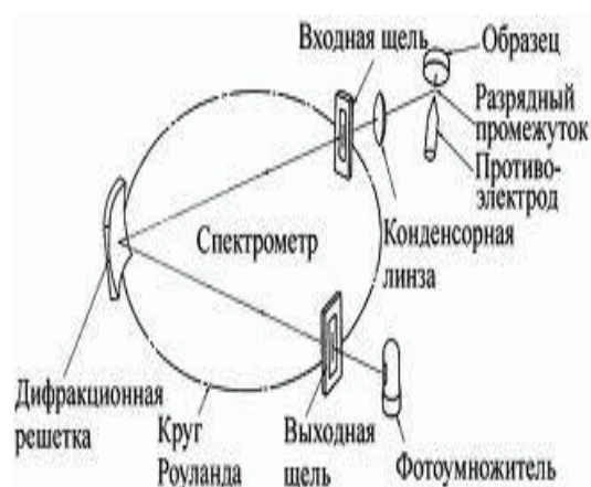
Рис.2.7. Схема пристрою спектрометра
