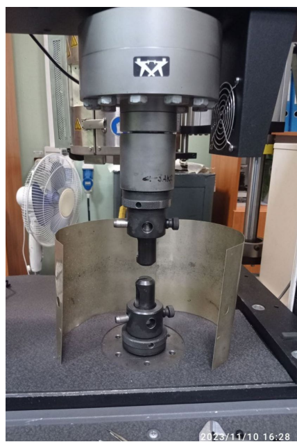
Рис. 2.2 – Стенд на одновісне статичне розтягнення при кімнатній та підвищеній температурі (система вимірювання параметрів досліджень Instron 3382).
