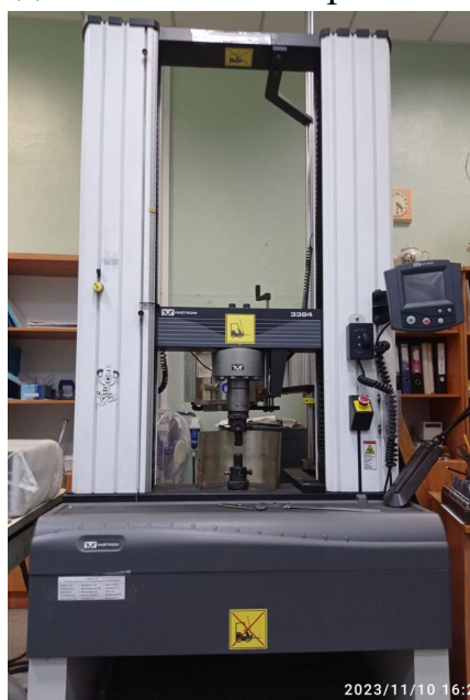
Рис. 2.2 – Стенд на одновісне статичне розтягнення при кімнатній та підвищеній температурі (система вимірювання параметрів досліджень Instron 3382).
