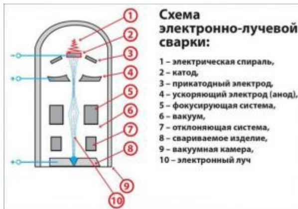
Рис.3.7. Схема електронно-променевого зварювання.
