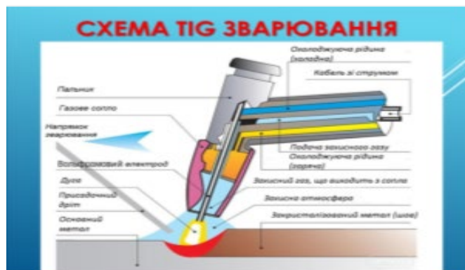
Рис. 3.1. Схема TIG зварювання неплавким електродом.
