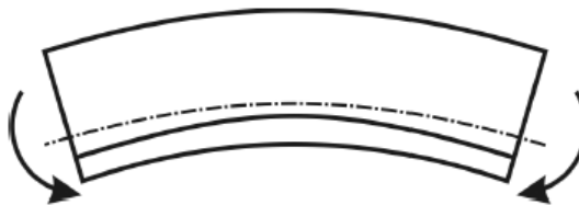
Рисунок 2.18 – Схема деформування балки після зварювання
