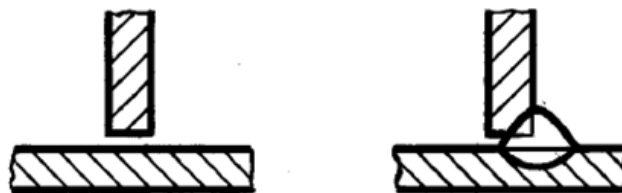
Рисунок 2.9 – Форма поперечного перерізу таврового з'єднання Т1
