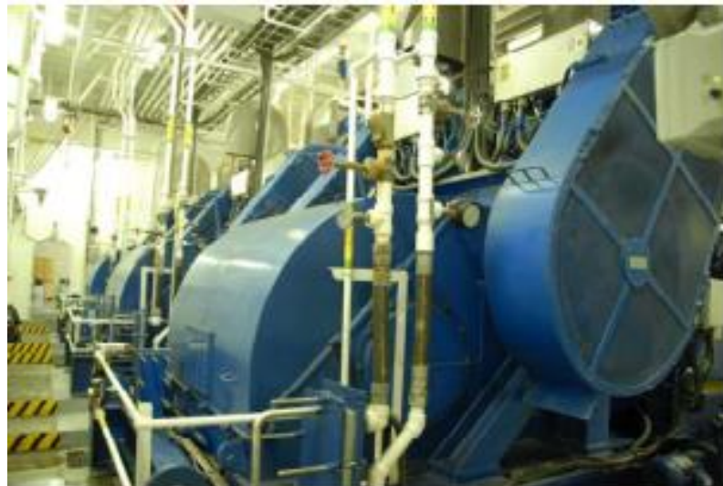
Рисунок 1.1 – Бурові насоси, керовані приводами з регульованою швидкістю
