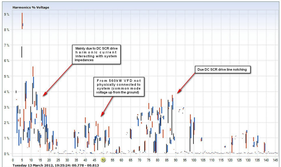
Рисунок 3.5 – Гармонічний спектр лінійної напруги, спричинений поєднанням тиристорних перетворювачів постійного струму та частотних перетворювачів частоти змінного струму
