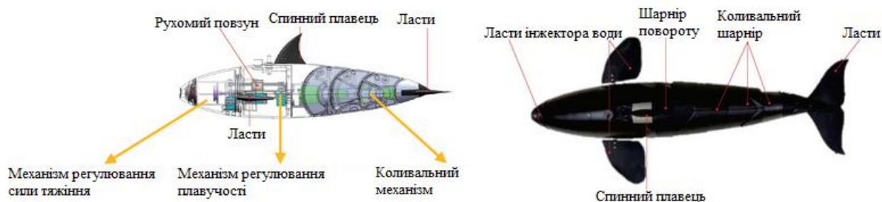
Рисунок 2 – Вертикально-осцилюючий рушій типу «дельфін/кит» [2]
