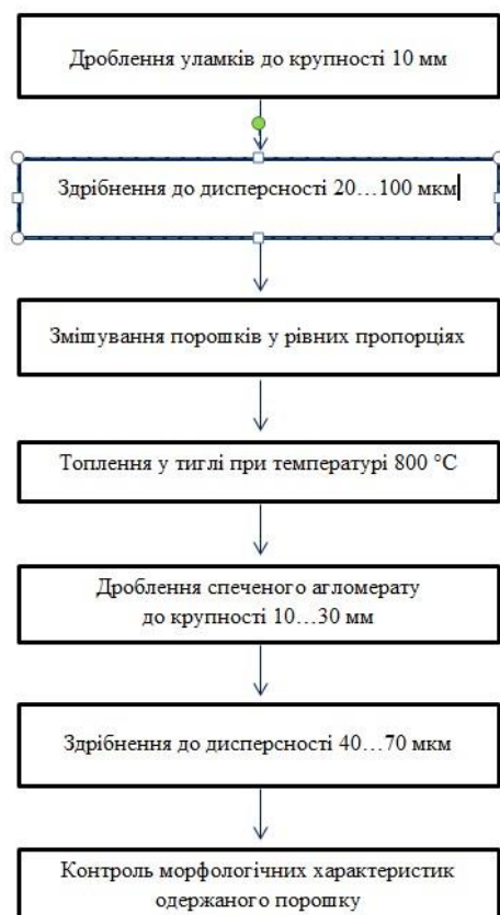
Рисунок 1 – Технологічна схема переробки бою скла та бракованих кристалевих виробів на склопорошок
