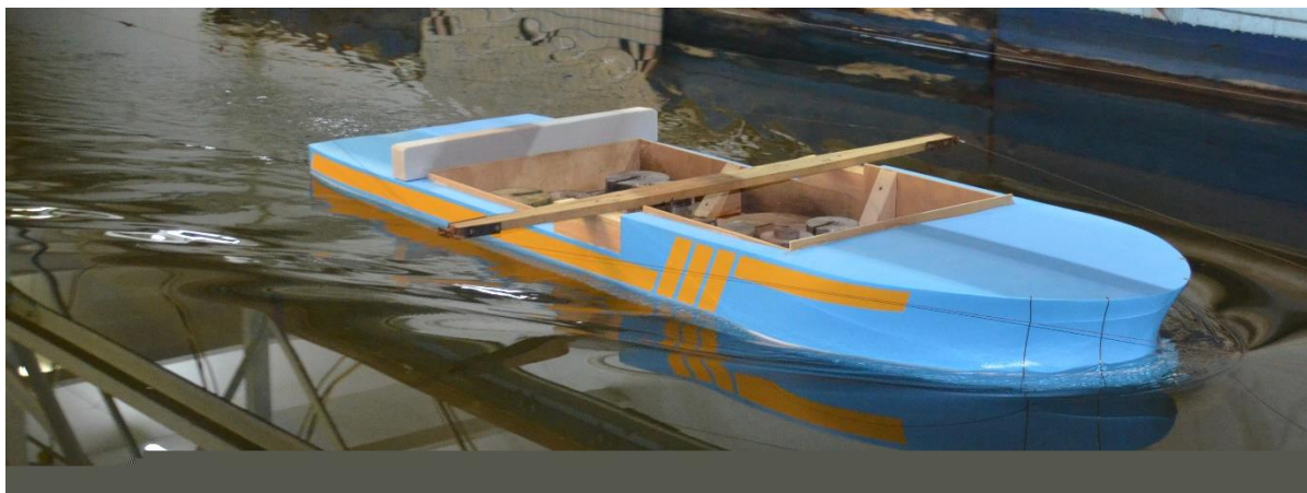
Рисунок 2 – Буксирування моделі на глибокій воді з розрахунковою швидкістю, Fr = 0,157
