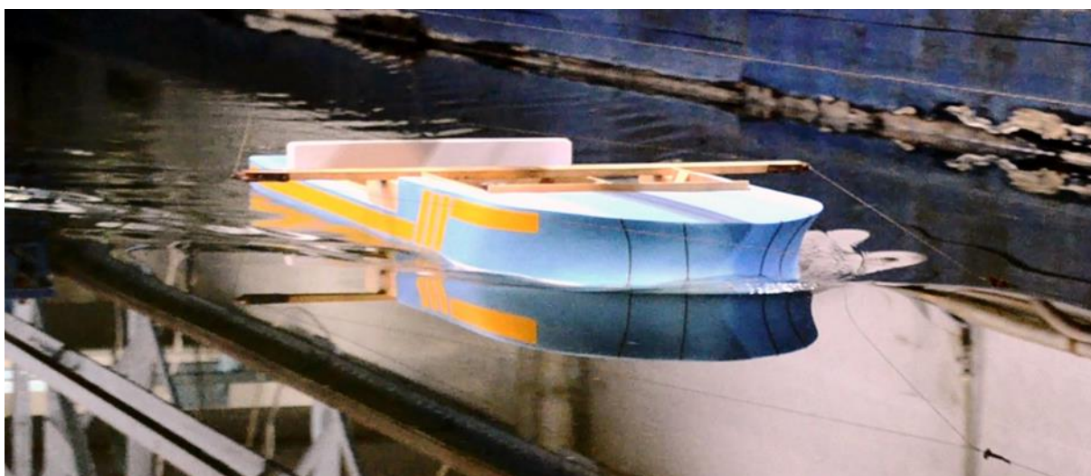
Рисунок 3 – Буксирування моделі зі швидкістю, близькою до граничної, Fr = 0,177
