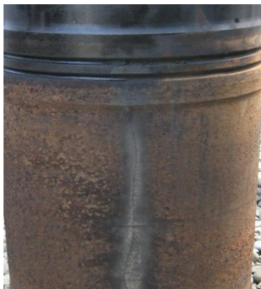
Рисунок 1 – Руйнування стінки втулки циліндру від детонації
