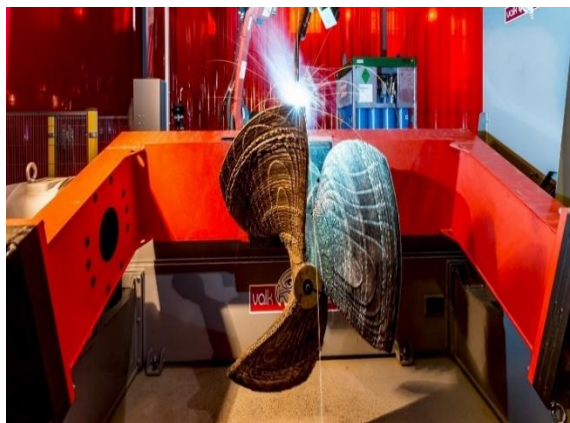
Рисунок 2 – Перший в світі гребний гвинт, що зроблений на 3-D принтері (джерело: [4])
