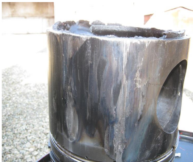
Рисунок 2 – Обрив тронку поршня
