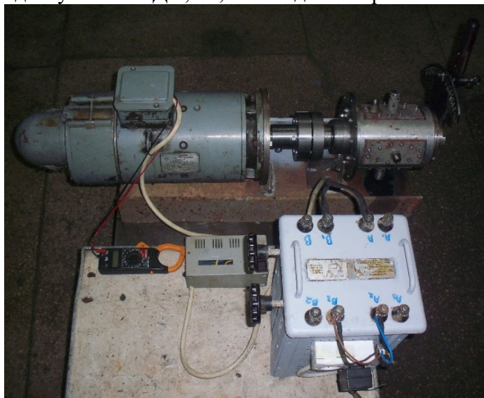
Рис. 1. Експериментальний стенд для визначення потужності механічних втрат роторно-поршневого двигуна перспективної конструкції
