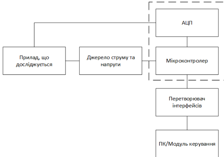
Рисунок 2 – Структурна схема вимірювального модуля
