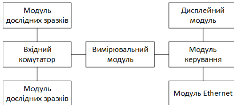
Рисунок 1 – Структурна схема лабораторного комплексу
