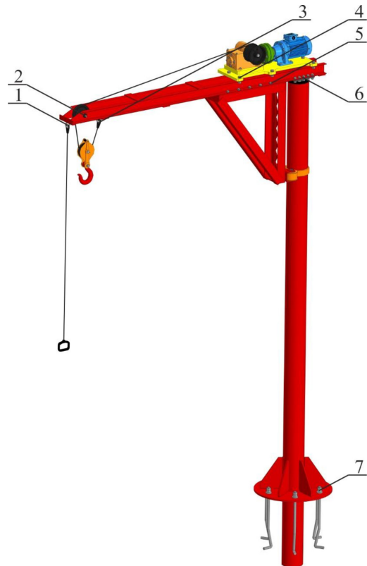
Рис. 5. Зовнішній вигляд 3D-моделі конструкції електропривода консольно-поворотного крана (вид збоку, ліворуч): 1) розчал для ручки; 2) кріплення канатного блока; 3) розчал гакової підвіски; 4) кріплення механізму підйому/спуску вантажу; 5) кріплення опорної частини консолі; 6) кріплення опорного підшипника; 7) анкерне кріплення
