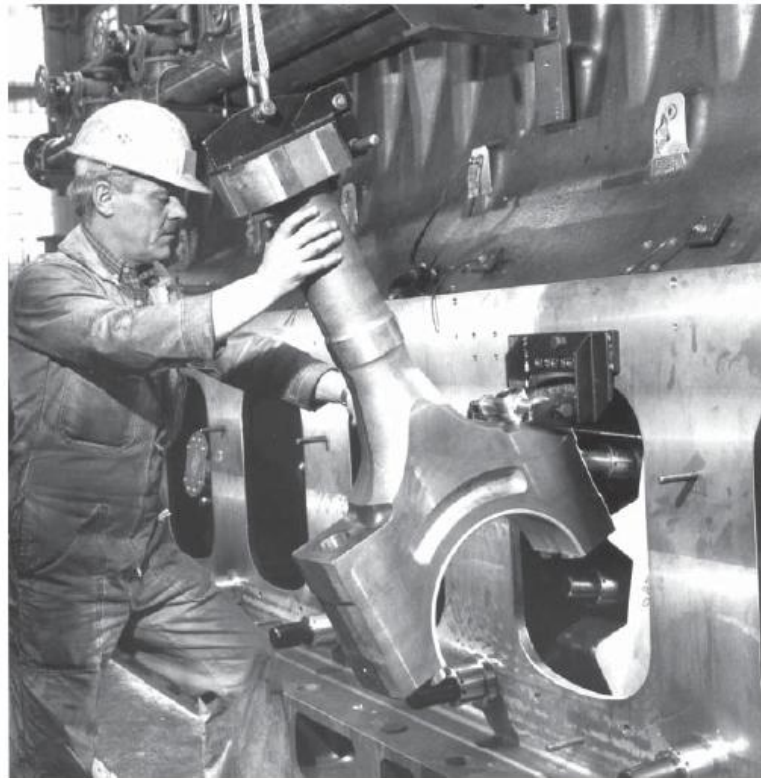
Рисунок 1.5 – Монтажні роботи по установці шатуна
