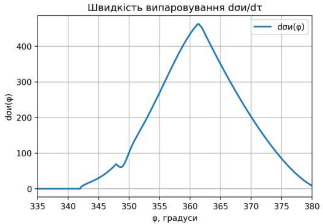
Рисунок 4.4 Швидкість випаровування палива
