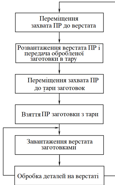
Рисунок 5.2 – Схема побудови типового алгоритму керування однопозиційним РТК
