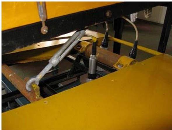
Рисунок 3.18 – Носова відеокамера макету апарата буксированої підводної системи
