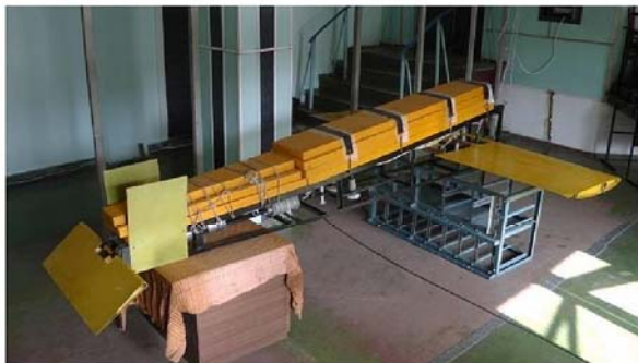
Рисунок 3.13 – Натуральний макет апарата буксированої підводної системи
