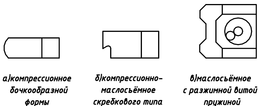
Рисунок 3.3 Профілі компресійних і маслоснімних кілець.
