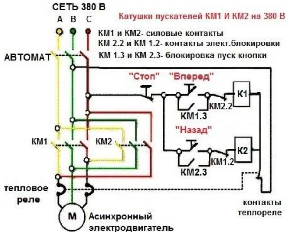
Рис. 1.3. Електрична схема реверсивного пускача серії ПММ
