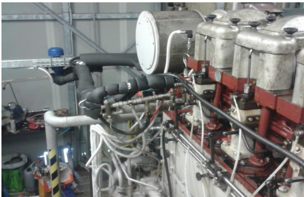
Рис. 3. Система подачі соєвої олії дизеля розміщено на випробувальному стенді
