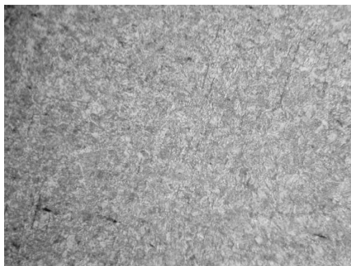
Рис.2.4. Результати дослідження мікроструктури зварного таврового з'єднання сталі 09Г2 (ГОСТ 14771-76 ТЗ-Δ4): a – основний метал, б – метал шва, в – ЗТВ; x200 (при друку зменшено в 3 рази)
