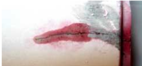
Рис. 6.3. Вигляд дефекту на поверхні після нанесення проявника
