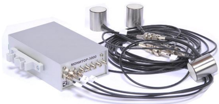
Рис. 4.2. Прилад акустико-емісійного контролю
