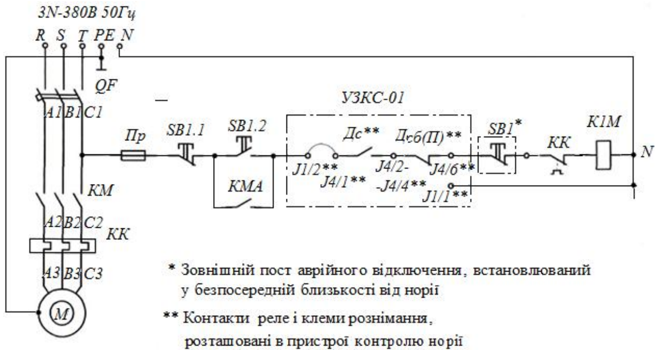
Рисунок 1.5 - Рекомендована схема електрична принципова керування норії
