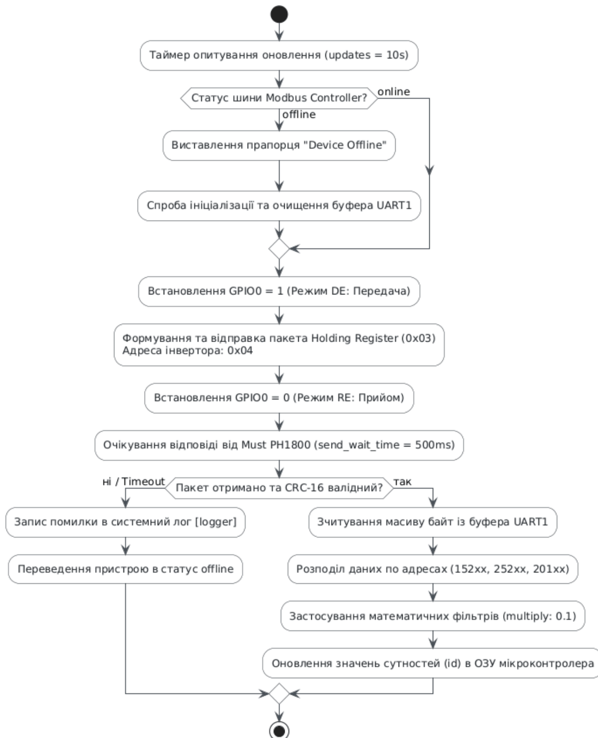
Рисунок 3.1 – Модуль драйвера обміну Modbus
